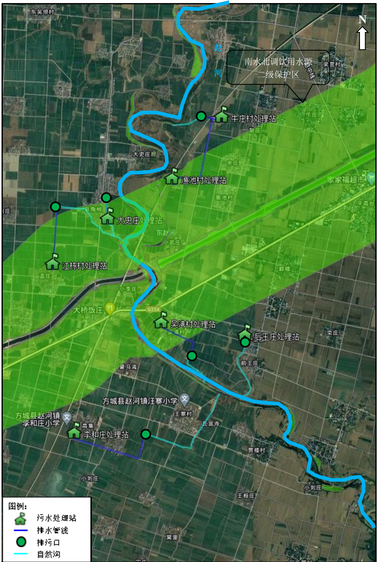
附图 7-3 污水站排污口与南水北调饮用水保护区位置关系示意图
