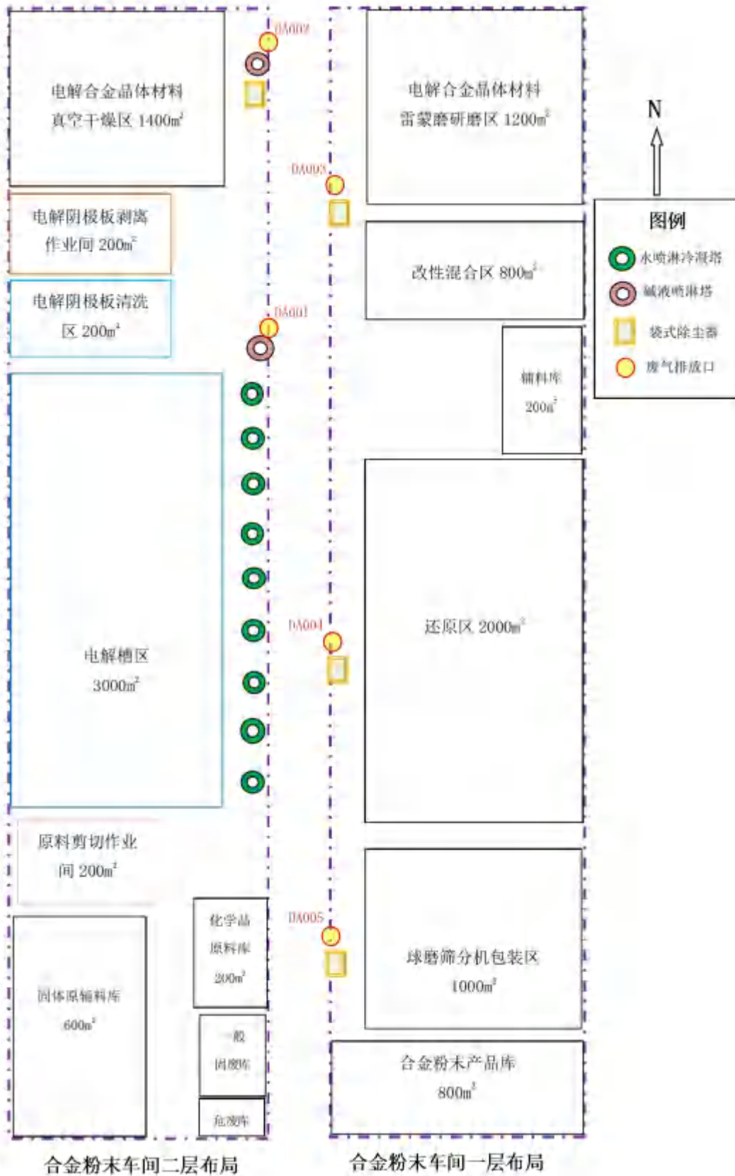
图 3.1-2 合金粉末车间平面布局示意图
